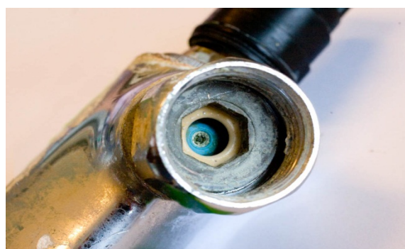
Keerklep EB in thermostatische douchemengkraan
